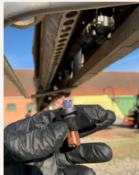
En del produkter har krav på avdriftsreducerande utrustning, t.ex. 50, 70 eller 90 % minskad vindavdrift från munstycket.
