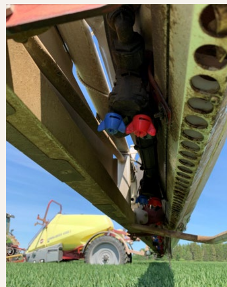
Med Autoselect på sprutan kan två munstycken växlas under körning. Antingen manuellt eller automatiskt genom ändring av tryck och/eller hastighet.
