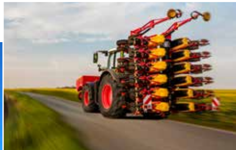
Alla Tempo V-modeller fälls ihop vertikalt till en transportbredd på 3 meter.
