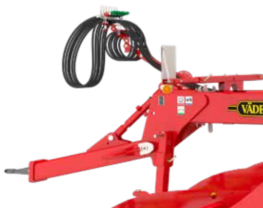
Rejäl slanghållare med färgmarkerade hydraulslangar.
