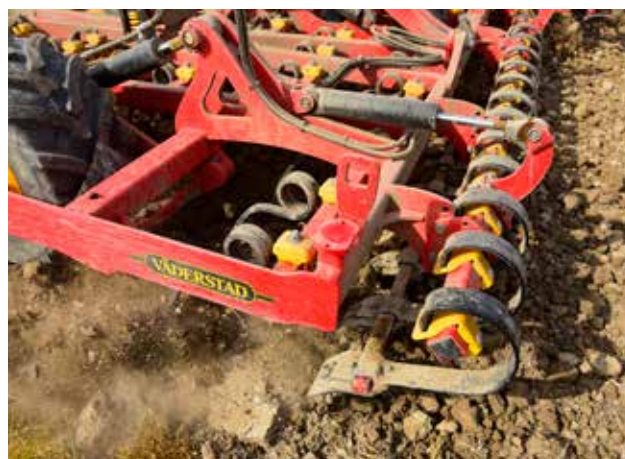
NZ Extreme har högre bearbetningskapacitet än NZA-harvar genom fler axlar, styvare pinne och ca 50 procent högre vikt per meter arbetsbredd.
