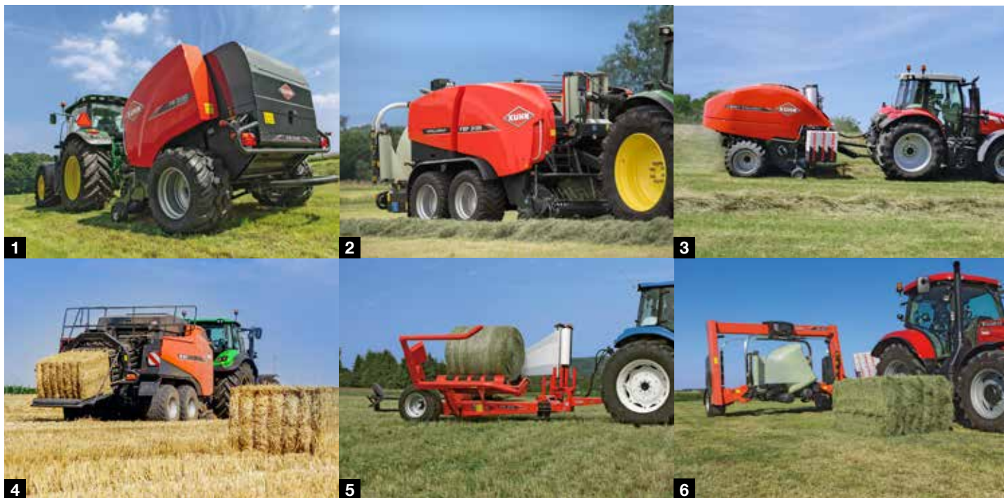
1. Balpressar med fixkammare – 2. BalePacks med fixkammare – 3. i-BIO+ – 4. Stora fyrkantspressar – 5. + 6. Balinplastare för rund- och fyrkantsbalar.
