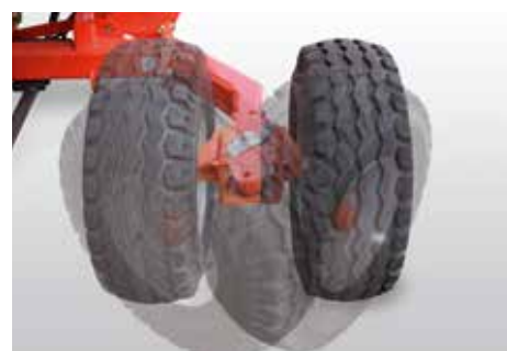
Under vägtransport kan det högra hjulet fällas in. Som tillval kan även det vänstra hjulet fällas in
