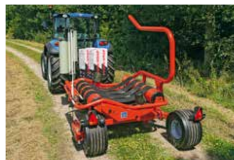
Vid vägtransport kan hjulen fällas in för att minska transportbredden
