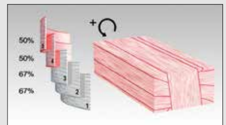
Sista 2 lagren med 50 % överlappning
