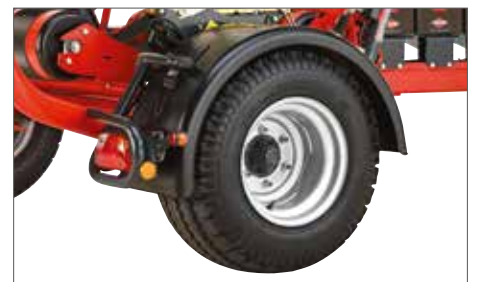
De stora stänkskärmarna ser till att skydda filmen från skador under transport
