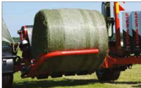
En snabb och mjuk pålastning av balen är garanterad tack vare den långa lastarmen
