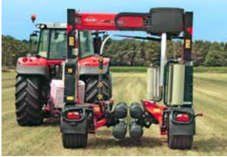
Inplastaren kan fällas ut från 2,5 m i transportläget till 4 m i arbetsläget
