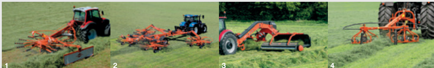
1. Burna med enkelrotor - 2. Halvburna med 4 rotorer - 3. Pickupsträngläggare - 4. Vändarkombinationer
