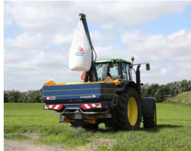
BXL 1300 kan lyfta upp till 1 300 kg och kan monteras på spridare upp till 3 300 liter.
